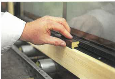
Mit Hilfe einer Schablone wird der exakte Sitz der Schiene kontrolliert
