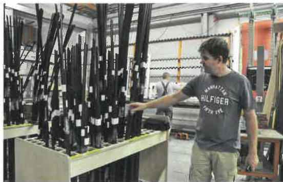
Die fertig zugeschnittenen Schienen stehen zur Weiterverarbeitung bereit
