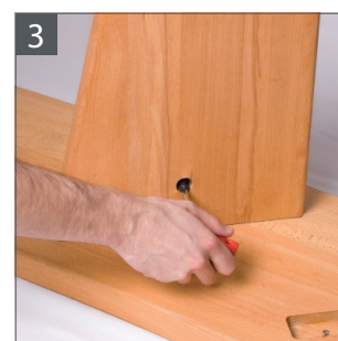
Dokręcanie (ściąganie) elementów (SW4)
