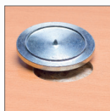
Przenoszenie środka wiercenia z pomocą punktaka
