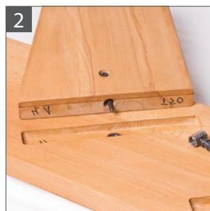
2 Positionner le goujon de serrage dans le perçage
