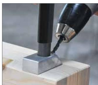
3 Percer en biais avec le gabarit de perçage Knapp.
