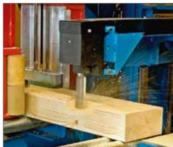
1 Réaliser le fraisage ou les perçages d'encastrement avec le centre d'usinage.
