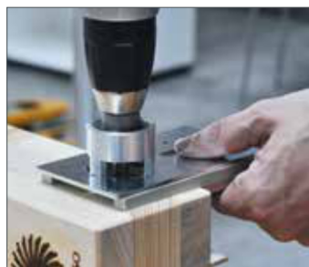
❶ Alternatywne przygotowanie ręczne przy użyciu szablonu wierceń KNAPP
