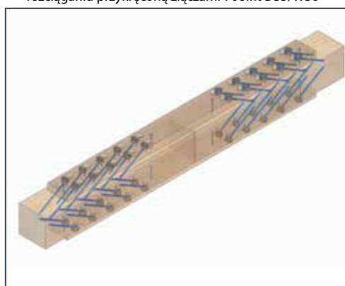
❹ Połączenie doczołowe belek z drewna BSH na styk połączone za pomocą nakładek z drewna liściastego zapobiegającymi rozciąganiu złączami T-Joint D35/W30
