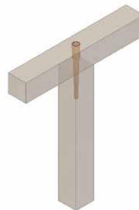
Połączenie doczołowe słup-płatew
