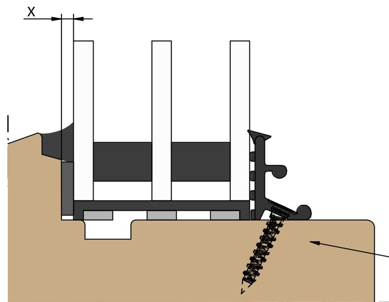
3. Placer FIXclip-Barre contre le vitrage et visser dans les trous prévus à cet effet avec un léger angle.
