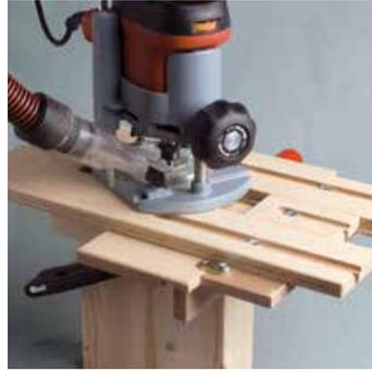
1) Usinage manuel avec gabarit et défonceuse portable. L'usinage en bout de traverse peut aussi se faire à la toupie.
