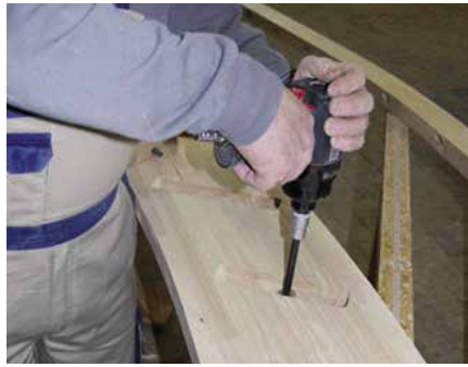
Eindrehen der Einschraubmutter mit dem Akkuschauber.
