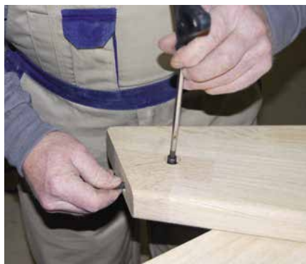
Ein leichtes Eindrehen der Inbusschraube fixiert den Verbinder.
