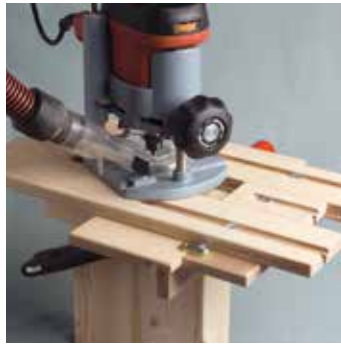
1) Usinage manuel avec gabarit et défonceuse portative.
