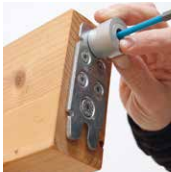
4) Vissage de la vis d'accroche en butée sur la collerette. La bague de réglage permet son ajustage si nécessaire. Lors du montage, ce réglage permet la garantie de joints d'assemblages toujours fermés.
