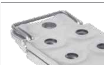
6) Si nécessaire la goupille peut être démontée. Il suffit de frapper sur son milieu avec un tournevis plat. La goupille se plie, sort des ergots et laisse l'assemblage libre.
