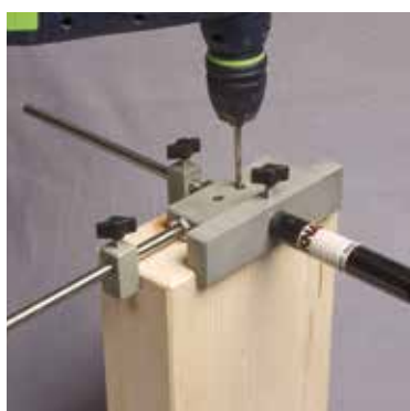
4) Pré-perçage avec le gabarit de perçage sur poutre secondaire
