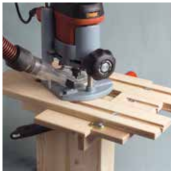
1) Usinage manuel avec gabarit et défonceuse portable.
