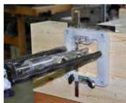
Bohren mit Stufenbohrer
