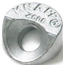
Le nouveau connecteur pour vis T-Joint de Knapp permet de renforcer la tenue des vis à 45° et de réaliser plusieurs types de fixations. Spécialement destiné aux connexions entre murs et dalles en CLT, il est positionné dans un évidement et permet de fixer durablement des éléments de construction tout en facilitant montage comme démontage.
