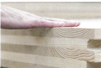
Fabricant de bois lamellé-collé et de bois massif reconstitué, fournisseur de bois de structure et de revêtements, Piveteau Bois a lancé fin 2017 son offre de bois lamellé-croisé CLT sous la marque Hexapli. Pour fabriquer son CLT en bois français, Piveteau Bois a investi 15 millions d'euros dans une unité de production à presse hydraulique de 50 000 m<sup>3</sup> de capacité par an.
