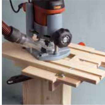
1) Mit der Frässhablone und Oberfräse wird am Riegel eine 40 mm breite und 12 mm tiefe Ausfräsung hergestellt (Länge laut Montageanleitung).
