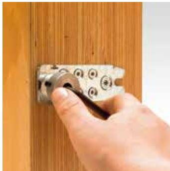
4) Die Halteschraube wird bis zur Schulter auf Anschlag eingedreht. Mit der Tiefenlehre ist die Halteschraube rationell einstellbar. Auch auf der Baustelle kann durch nachstellen eine fugendichte Verbindung garantiert werden.
