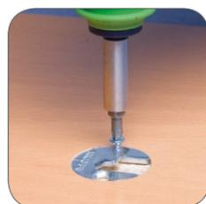
3) Visser avec les vis tête fraisée  $\varnothing 3,5$  mm
