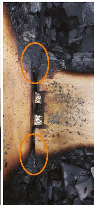
Die 10mm Fuge wird durch das aufquellende Brandschutzlaminat geschlossen, wodurch der Verbinder auch nach 120min Branddauer gut geschützt ist.
