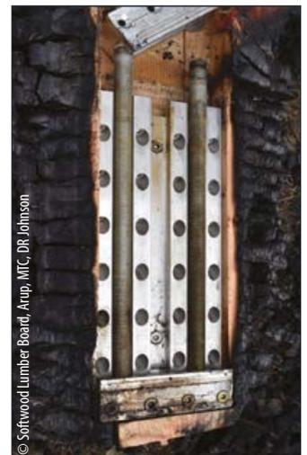
RICON®S Verbinder nach 120 minütigem und MEGANT® Verbinder nach 60 minütigem Brandversuch. Das Holz ist rings herum verkohlt. Die Verbinder hielten in dem Brandversuch der aufgebrauchten Vertikallast stand.
