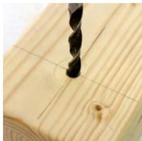
Vorbohren der Positionierschraubung.
