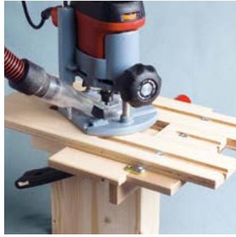
Mit der Frässchablone und Oberfräse wird am Riegel eine 60 mm bzw. 80 mm breite und 25 mm tiefe Ausfräsung hergestellt (Länge laut Montageanleitung).
