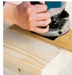
Abbundmaschine oder Ausfräsen mit Oberfräse
