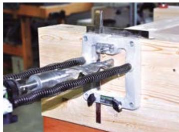
Bohren mit Stufenbohrer manuell oder industriell mittels Abbundanlage.
