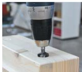
T-JOINT D20 Bohrung ca. 3 mm ansenken.
