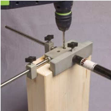
Pré-perçage poutre secondaire
