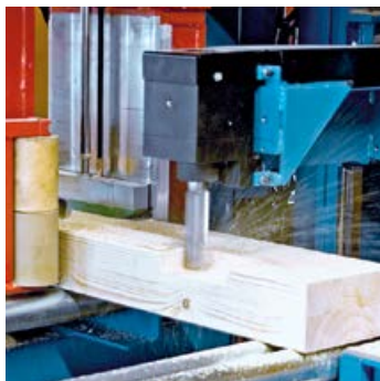
Usinage sur centre de taille numérique
