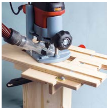
Usinage manuel avec gabarit et défonceuse portable (cf. notice de montage pour le positionnement et les dimensions).
