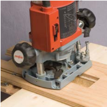
Usinage manuel avec gabarit et défonceuse portative
