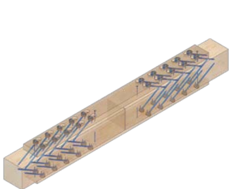
Aboutage de lamellé-collé avec T-JOINT D35 W30 monté sur des tirants en lamellé feuillu.
