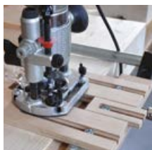
Usinage avec gabarit
